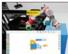
生産ラインが稼働していてもOK JAKA App(スクラッチ)でのプログラミング& 再生するとSF Twin Cobotのロボットが動く
